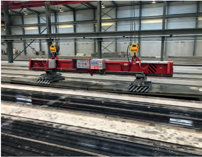
Levage des dalles alvéolées à l'aide d'un palonnier télescopique monté sur pont roulant
