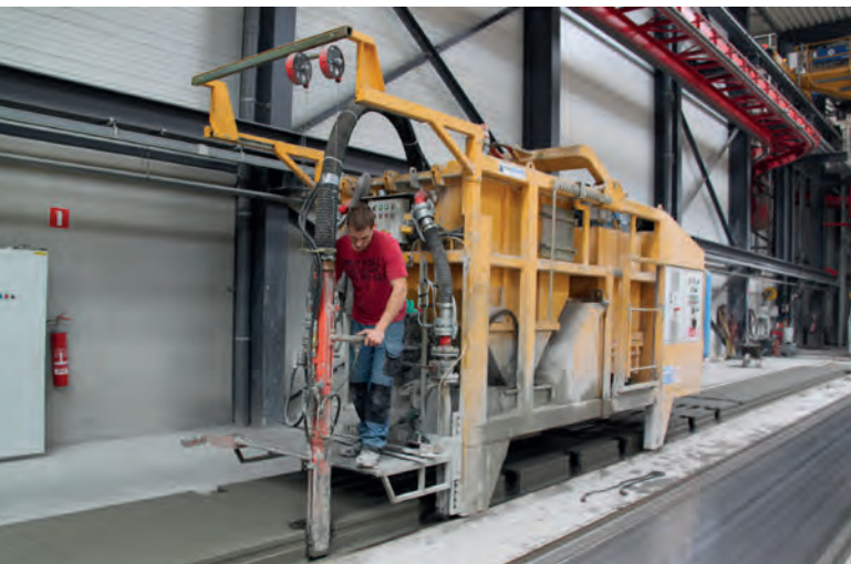
Aspirateur à béton à fonctionnement manuel utilisé à l'usine de Malle
