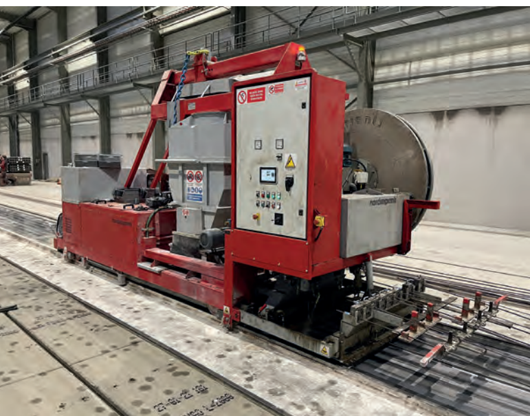
Machine de nettoyage multifonctions pour bancs de préfabrication conçue par Nordimpianti
