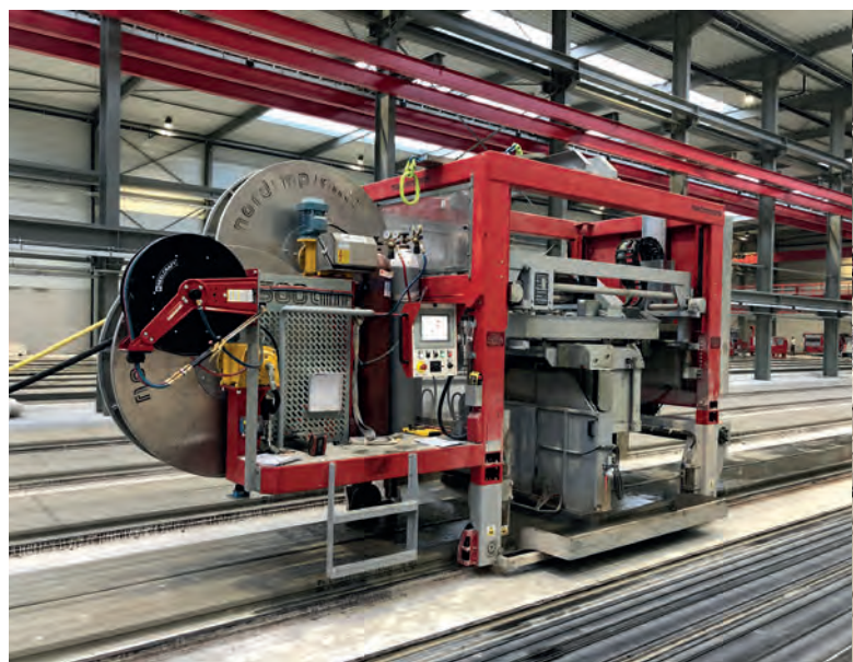
Machine de découpe automatique à angle réglable de Nordimpianti
