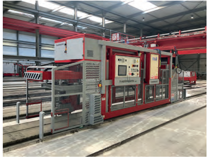
Levage des dalles alvéolées avec la nouvelle machine d'empilage automatique de Nordimpianti
