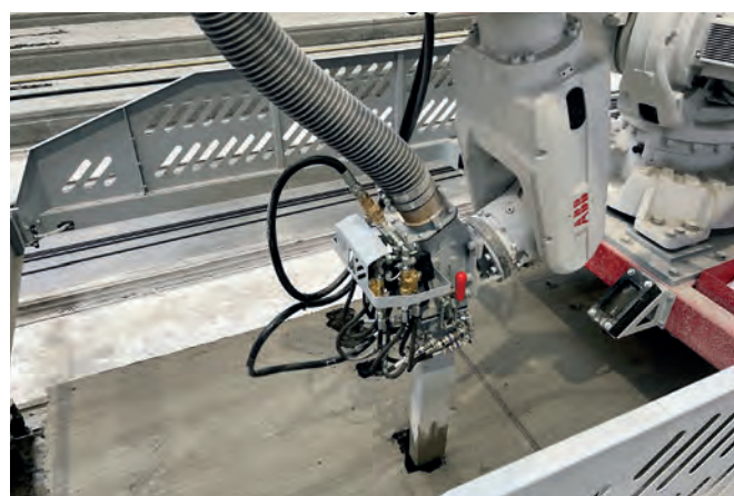
Le nouvel aspirateur à béton automatique, développé par Nordimpianti pour l'usine de Tessenderlo
