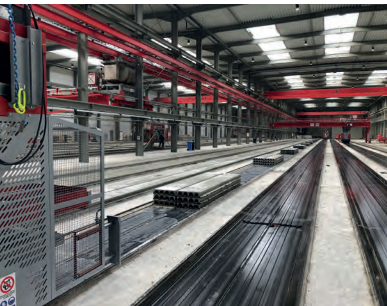
Piles de dalles alvéolées disposées le long du banc de production
